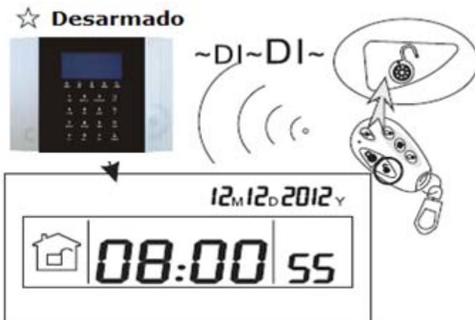
Pulse la tecla de desarmado en el mando a distancia o teclado táctil de la consola o introduzca la contraseña de usuario en el teclado; oirá un pitido de confirmación y un mensaje "system disarmed" (sistema desarmado).
