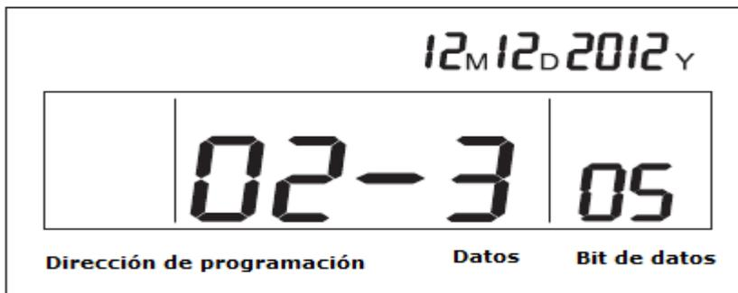
Pulse la tecla ARRIBA y ABAJO para seleccionar y modificar los diferentes bits de datos.
